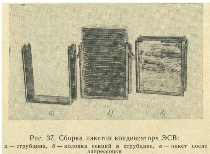
В процессе сборки и запрессовки пакетов могут возникать следующие дефекты: механические повреждения диэлектрика и алюминиевой фольги при выравнивании токоподводов в секциях, а также секций при сжатии и др.
