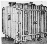
Рис. 55. Термовакuumный шкаф для сушки и пропитки конденсаторов
